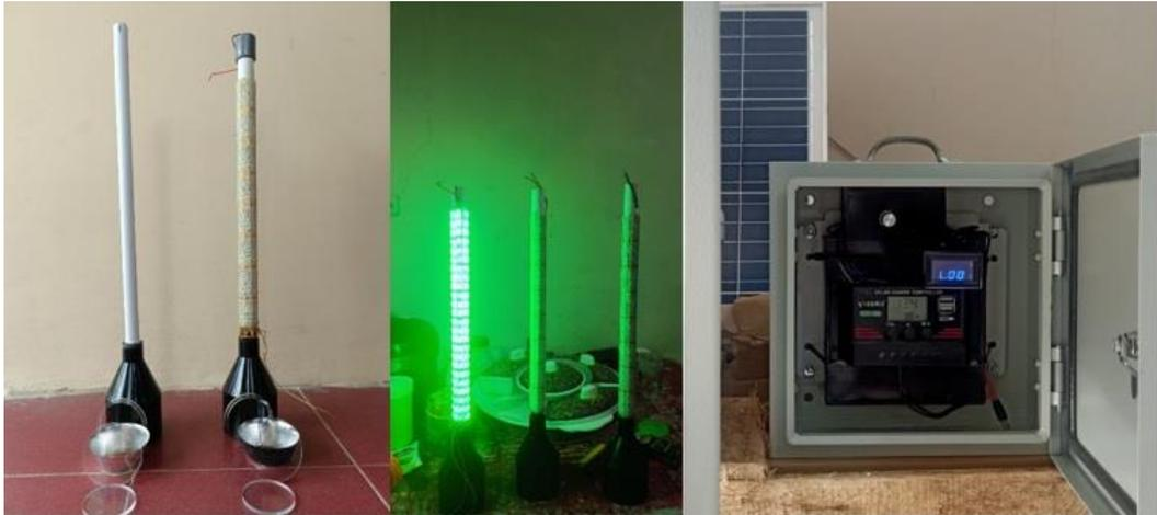
Gambar 5.2. Komponen Sistem LaBrida: Lampu celup, box controller dan panel
