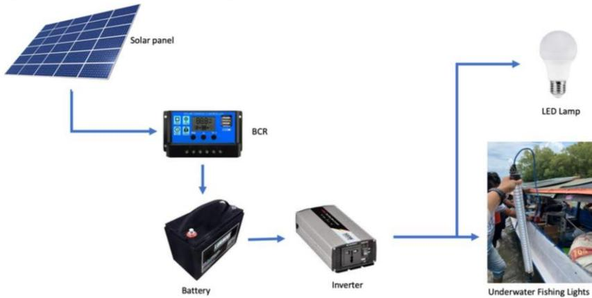
**Gambar 2.4.** Contoh penerapan energi surya untuk lampu penangkapan ikan bawah air (Nugraha, dkk, 2022)
