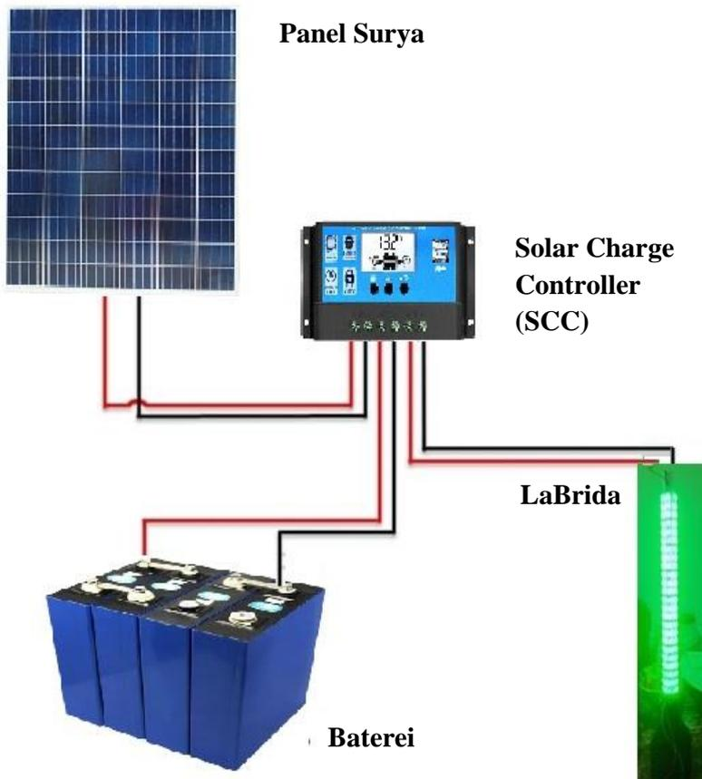
**Gambar 5.1.** Rangkaian sistem LaBrida terintegrasi PLTS
