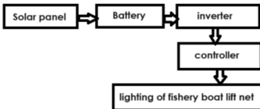
**Gambar 2.2.** Skema Generator PV Portabel untuk Penerangan Kapal (Rahman, Y. A., dkk. (2023)
